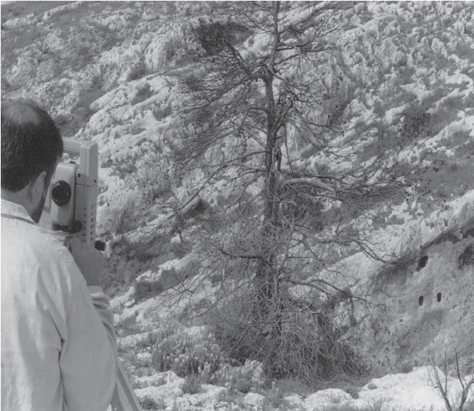
Situación de las bocas mediante teodolito.
